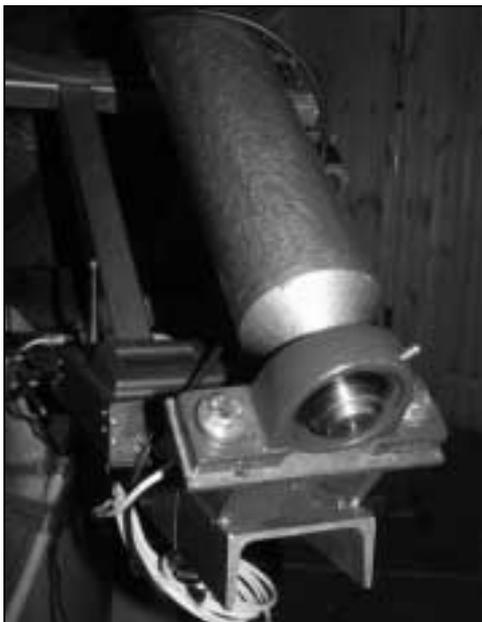
> fig. 2: il cuscinetto di appoggio della parte Sud dell'asse polare
