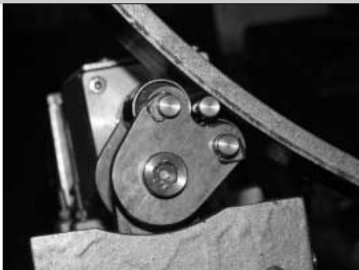
> fig. 1: il rullino di trascinamento dell'ascensione retta
