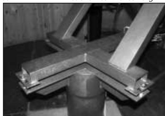
> fig. 5: la croce d'appoggio in acciaio, regolabile in azimut ed elevazione
