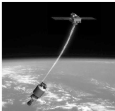
Esempio di collegamento navicella con un satellite tethered
